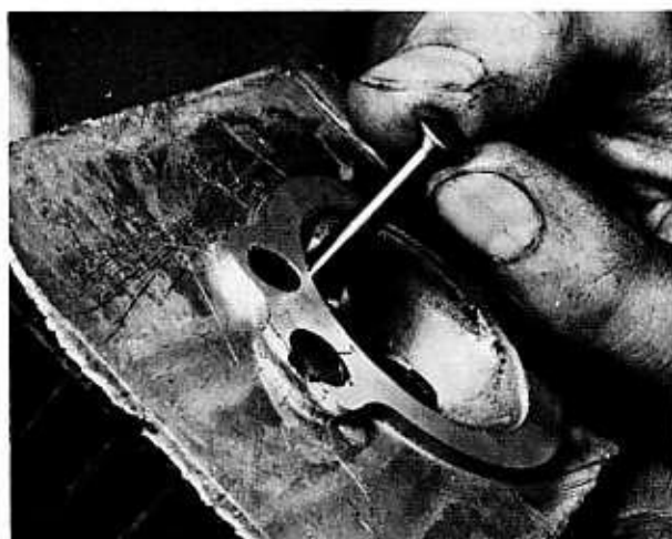
Bild 31 Das Ventil wird nach der Innenseite des Zylinderkopfes ausgebaut
