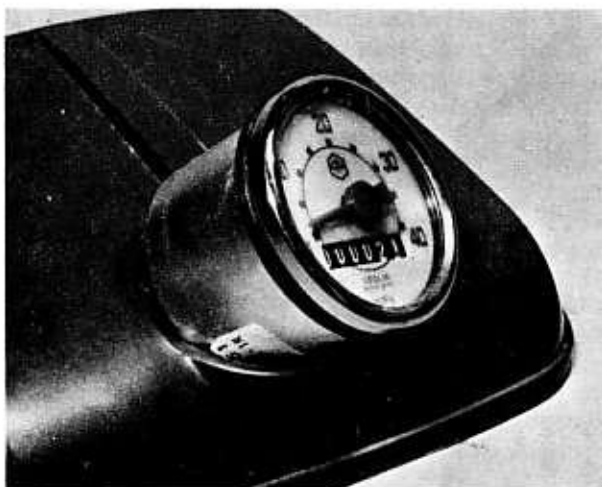
Bild 129 Der Geschwindigkeitsmesser sitzt im Scheinwerfergehäuse ...
