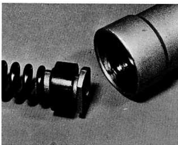
Bild 122 ... hält den Halter für Schraubenfeder fest
