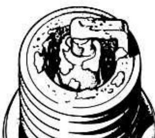
Bild 101 Weisse Ablagerungen durch Ölüberschuss in Brennraum oder durch ungenügende Ölqualität. Ablagerungen entfernen, sonst können Glühzündungen entstehen
