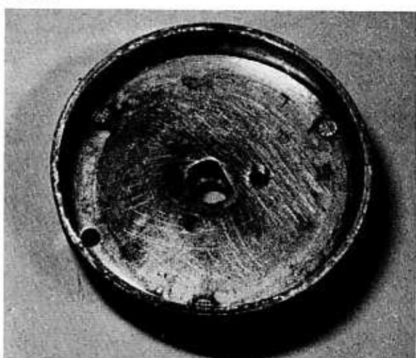
Bild 50 Der Deckel dient auch als Trommel für die Anlasskupplung
