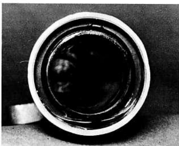
Bild 120 Ein abgenutzter Dichtring muss ersetzt werden
