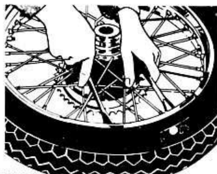
Bild 150 Mit zwei Montierhebeln wird der Reifenwulst über das Felgenhorn gehoben
