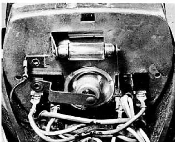
Bild 161 Die Soffittenlampe ist zwischen Laschen eingeklemmt
