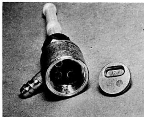
Bild 82 Das Benzin läuft durch den Schlitz in der Aluminiumscheibe
