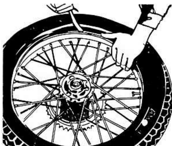
Bild 154 Der erste Reifenwulst wird über das Felgenhorn gehoben, zuletzt mit Hilfe eines Montierhebels
