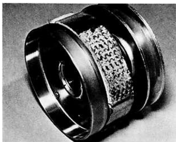
Bild 75 Prüfen der Kupplungsbeläge
