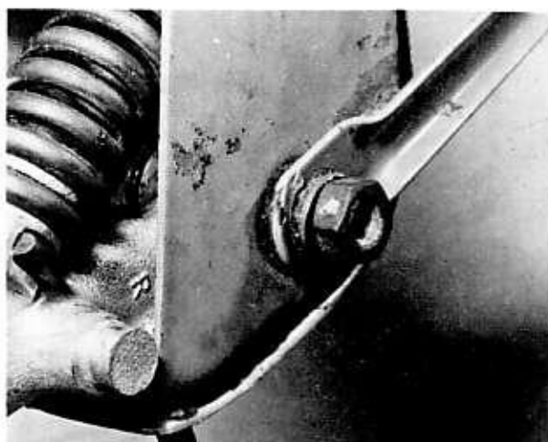
Bild 108 Zum Ausbauen der Schwinge muss der Lagerbolzen herausgenommen werden
