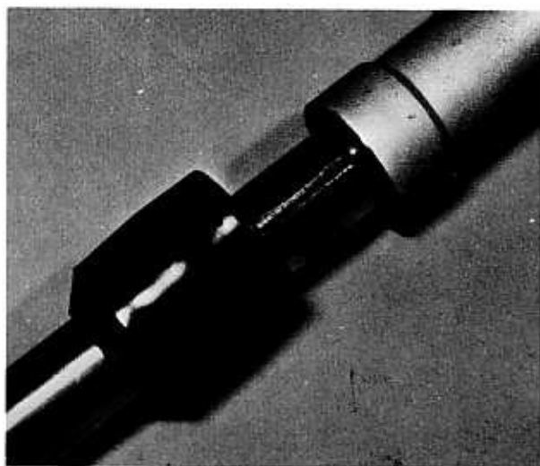
Bild 117 Nach dem Abziehen der Staubschutzmanschette kann das Gabelrohr zerlegt werden
