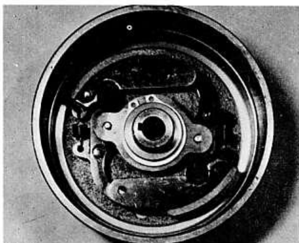
Bild 76 Die Backen der Anlasskupplung sind mit einem Sicherungsring und einem Haltering befestigt
