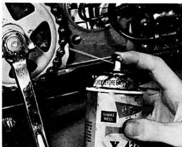
Bild 67 Schmieren der Pedalkette mit Kettenspray
