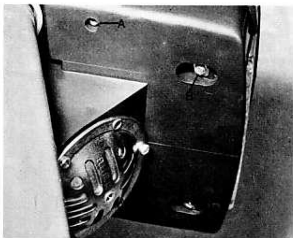
Bild 158 Scheinwerferbefestigungsschrauben (A) und -einstellschrauben (B)
