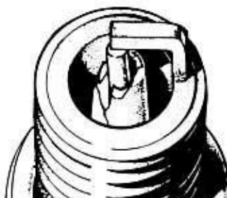
Bild 105 Abgenutzte Zündkerzen führen nicht nur zu höherem Kraftstoffverbrauch, sondern auch zu einer Überlastung der Zündanlage durch die höhere Spannung am grösseren Elektrodenabstand und zu Luftverschmutzung
