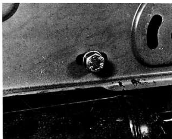
Bild 12 Befestigungsschraube des Auspufftopfes
