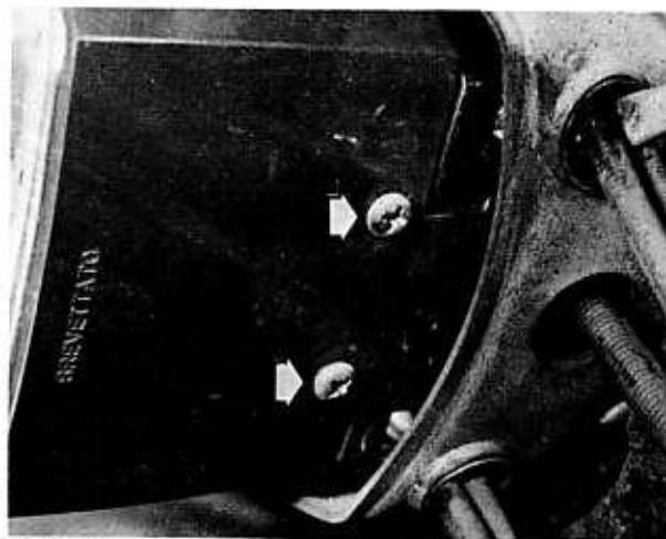
Bild 159 Frühere Ausführungen sind nur mit Befestigungsschrauben versehen (Pfeil)
