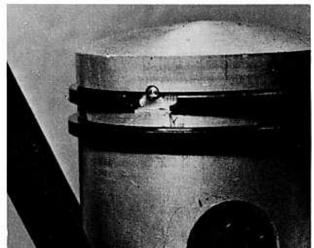
Bild 37 Kolbenringe so einbauen, wie das Bild zeigt
