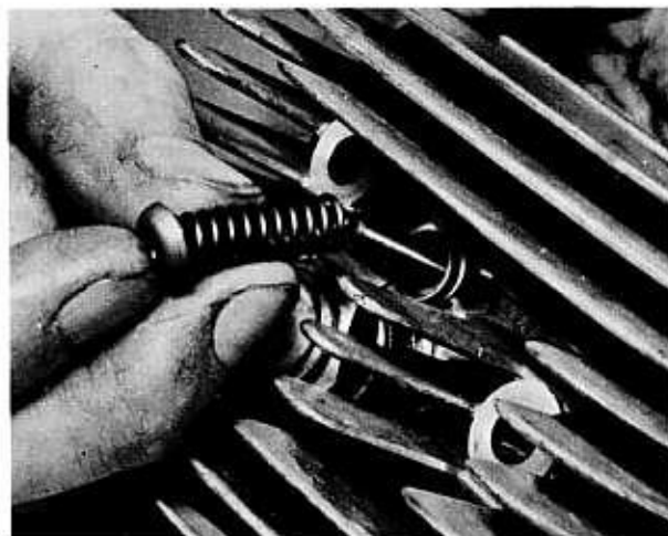
Bild 30 Ausbau der Ventilsfeder mit den Federtellern
