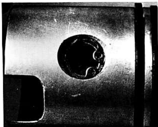
Bild 21 Die Kolbenbolzensicherungen dürfen nicht wieder verwendet werden
