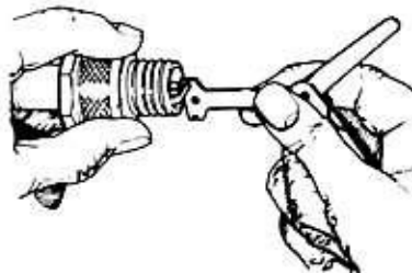
Bild 99 Einstellen des Elektrodenabstandes mit Spezialwerkzeug
