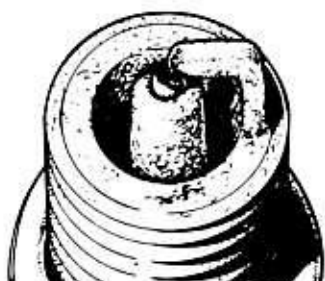
Bild 104 Ein blasig verbrannter Isolator oder angeschmolzene Elektroden deuten auf zuviel Frühzündung oder mangelhafte Kühlung. Falls kein Fehler am Motor vorliegt, nächstkälteren Kerzentyp verwenden
