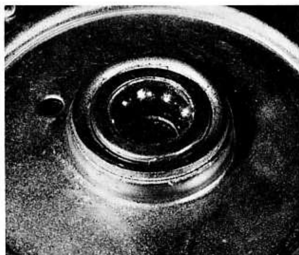
Bild 135 Die Lagerkugeln werden von einem Stahlring gehalten
