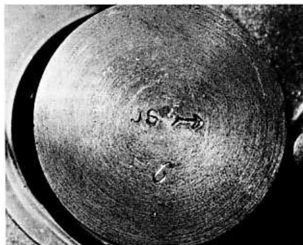
Bild 34 Der Pfeil auf dem Kolbenboden muss nach unten zeigen
