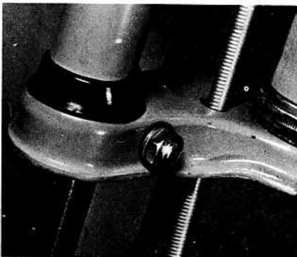
Bild 114. Das Standrohr ist in der unteren Gabelbrücke festgeklemmt
