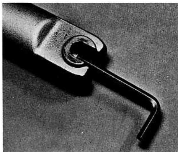
Bild 116 Der Halter für die Schraubenfeder ist mit einer Innensechskantschraube befestigt
