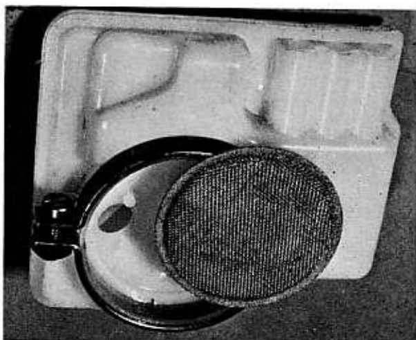
Bild 93 Der Siebeinsatz des Luftfilters wird in Benzin gereinigt
