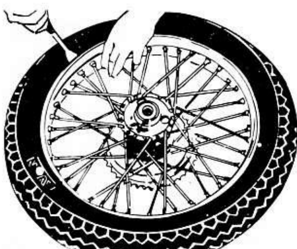
Bild 156 Damit der Schlauch nicht eingeklemmt wird, soll das Ventil in die Reifendecke hineingedrückt werden
