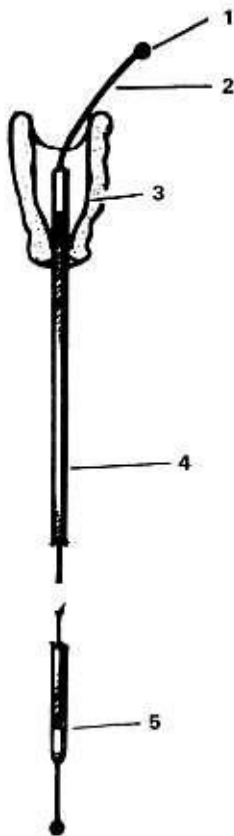
Bild 8 Schmieren der Seilzüge
