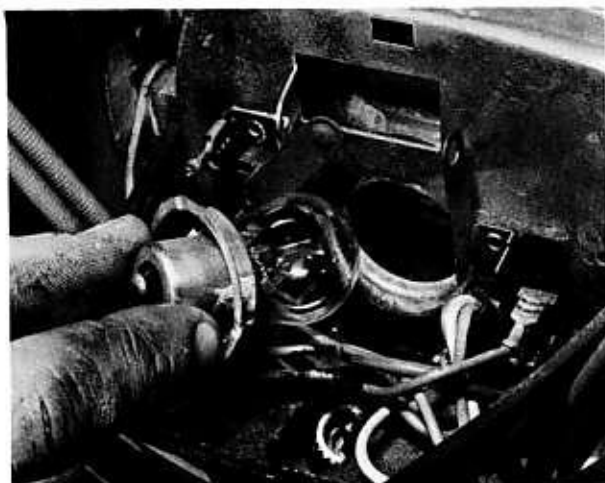
Bild 9 Zum Herausnehmen der Scheinwerferlampe Kontaktzunge zur Seite drehen
