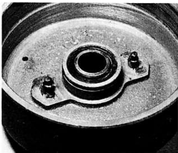
Bild 49 Die Kupplungstrommel muss gereinigt und die Achszapfen geschmiert werden
