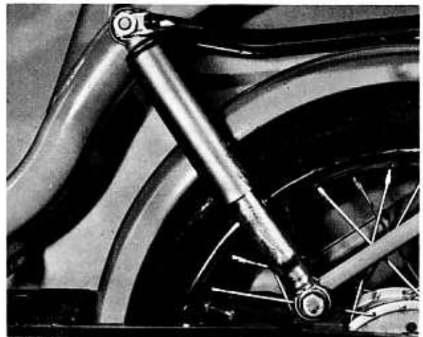
Bild 124 Das hintere Federbein ist mit einer Schraube und einer Stiftschraube befestigt
