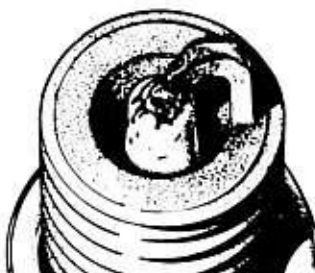
Bild 103 Feuchte, ölige Kohleablagerungen durch einen Nebenschluss am Isolator und Zündaussetzer. Die Ursache kann fortgeschrittene Motorabnutzung oder eine schlechte Funktion der Zündanlage sein
