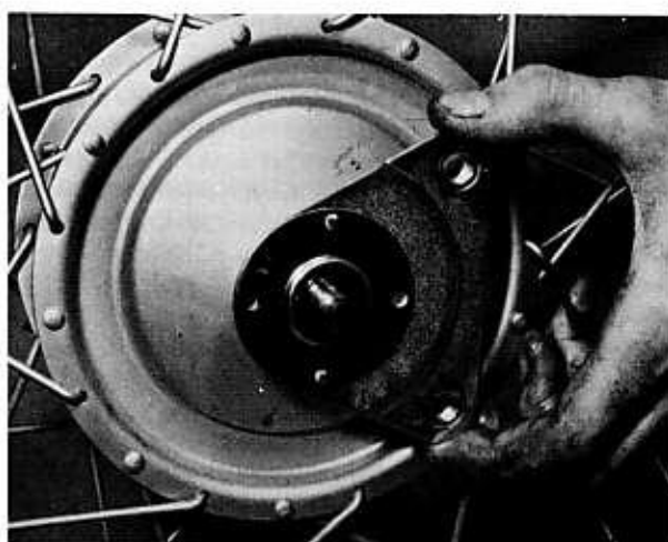
Bild 145 Das Kugellager sitzt in diesem Lagerschild
