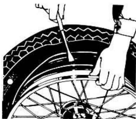
Bild 151 Der zweite Reifenwulst wird auf die gleiche Seite abgehelt wie der erste
