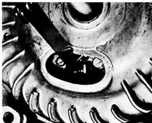
Bild 95 Messen des Unterbrecherkontaktabstandes mit einer Fühlerlehre
