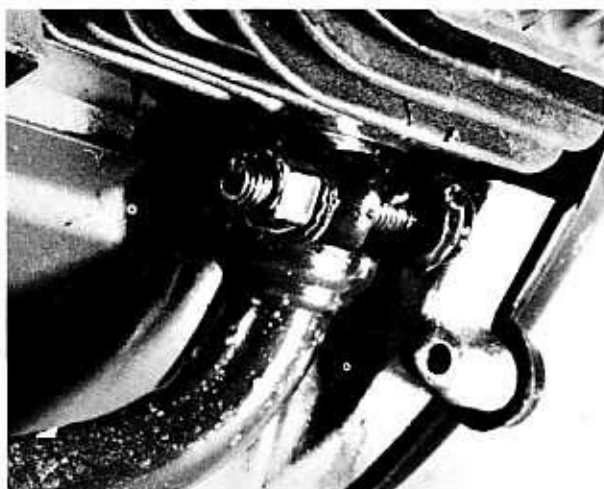
Bild 11 Das Auspuffrohr ist mit einer Klemme am Zylinder befestigt
