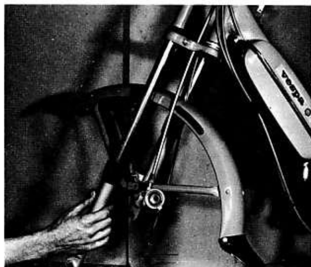
Bild 115 Beim Ausbau der Gabel bleiben die Verkleidungsrohre an Ort
