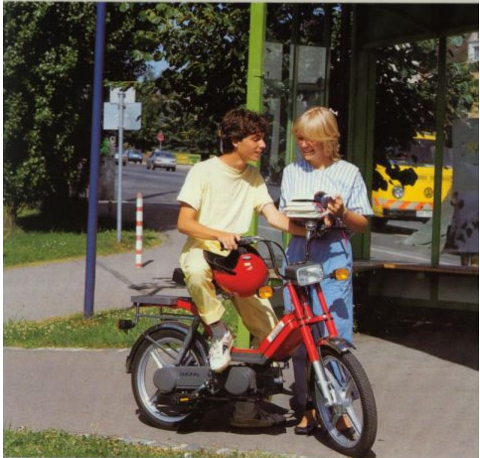
Die Modellreihe Bravo wird in 4 verschiedenen Varianten angeboten. Alle sind serienmäßig mit Telegabel, Stoßdämpfern, Druckgußrädern, Gepäckträger, Tachometer und abschließbarem Gepäckhaken ausgestattet. Der millionenfach bewährte Drehschiebermotor mit Keilriemenantrieb sorgt für problemloses Fahren.
