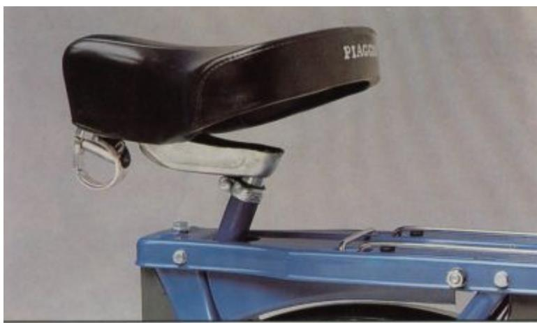
Die Spezial-Sattelfederung bei den Ciao-PX-Modellen bietet hohen Fahrkomfort.
